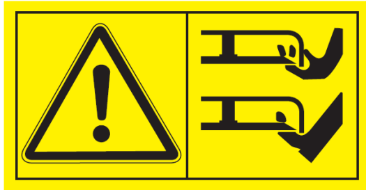
Danger ! Risques de sectionnement. Lame en rotation. Ne pas s'approcher de l'outil de coupe
